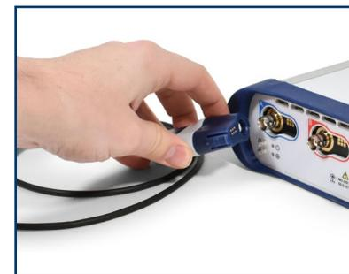
Sugli oscilloscopi PicoScope serie 6000E sono montate quattro interfacce per sonde intelligenti.
