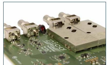
Schermatura del front end di PicoScope 2206
