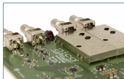
Schermatura del front end di PicoScope 2206
