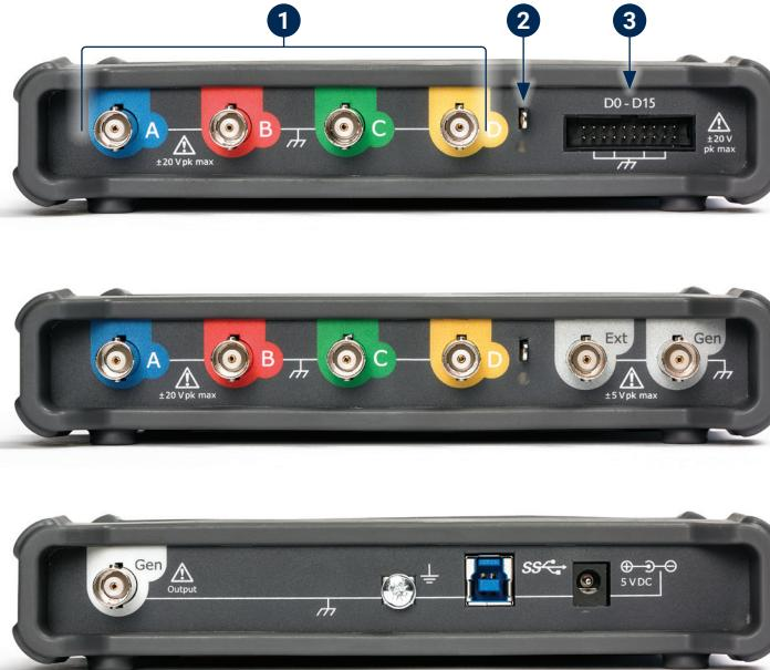
Nota: A seguire vengono mostrati i modelli a 4 canali PicoScope serie 5000D. Altri modelli possono avere una diversa disposizione di connettori. Per dettagli consultare la scheda dati dell'oscilloscopio.
