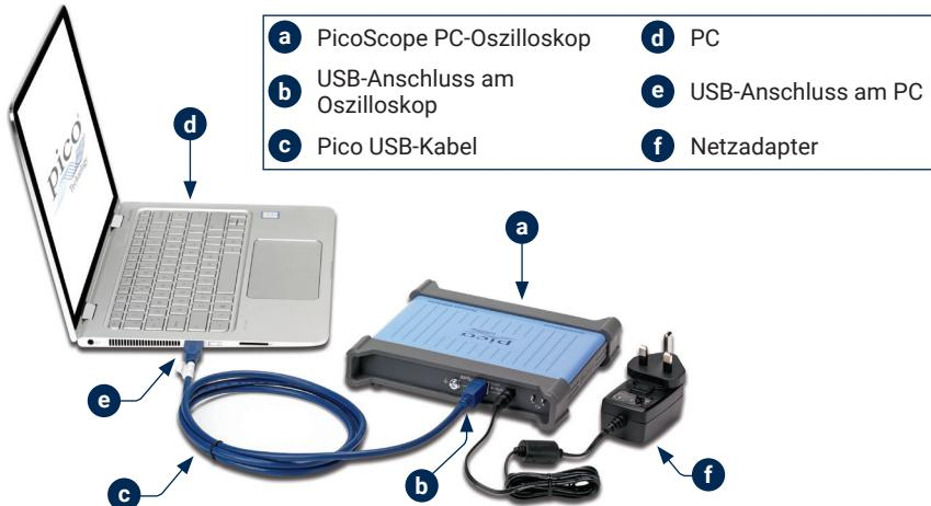
3. Abwarten, bis das Oszilloskop auf dem PC installiert ist. Währenddessen erscheint eine Meldung oder ein Symbol in der Taskleiste, und meldet, dass das Gerät gefunden wurde.
