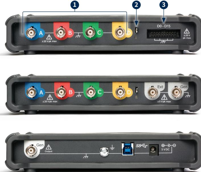
注: 図は、PicoScope 5000Dシリーズ 4チャンネルモデルです。他のモデルのコネクタは、異なる場合があります。詳細は、お使いのオシロスコープのデータシートを参照してください。
